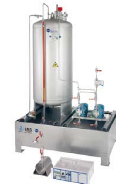
Model: 2MLeX 040.5/8-NS-T200 składa się z 2 pomp pomiarowych model MLeX 040 (dane techniczne patrz strona 4) zbiornika nawanianego wielkość 200l korytka wyciekowego wykonanego ze stali nierdzewnej, sprawdzonego pod kątem wycieku zgodnie z przepisami Niemieckiego Stowarzyszenia Branży Gazowej i Wodnej (DVGW)
