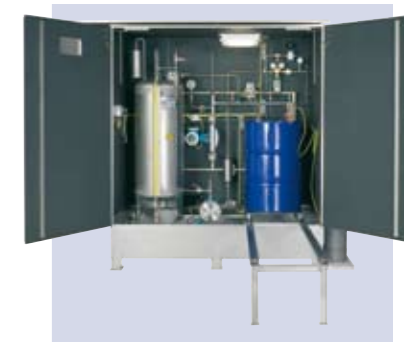
Model: MRX 30.22-SC-T200 składa się z 1 pompy pomiarowej model MRX 30.22 zbiornika nawanianego wielkość 200l szafki ze stali nierdzewnej z oświetleniem, izolacją termiczną i grzejnikiem korytka wyciekowego wykonanego ze stali nierdzewnej, sprawdzonego pod kątem wycieku zgodnie z przepisami Niemieckiego Stowarzyszenia Branży Gazowej i Wodnej (DVGW)
